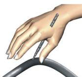
Não verifique vazamentos no circuito hidráulico com as mãos, pois a alta pressão pode provocar grave lesão.
