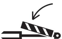
Sempre utilizar as travas para efetuar a manutenção e o transporte dos equipamentos.
